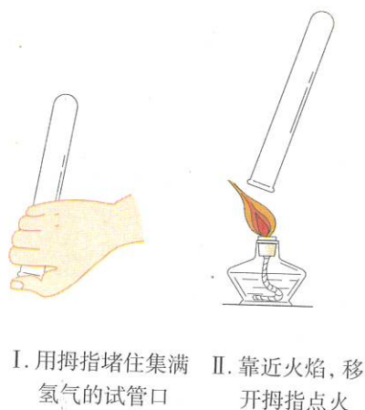
图4-23 检验氢气的纯度
