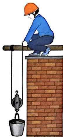
图 11-31 用滑轮提升建筑材料
